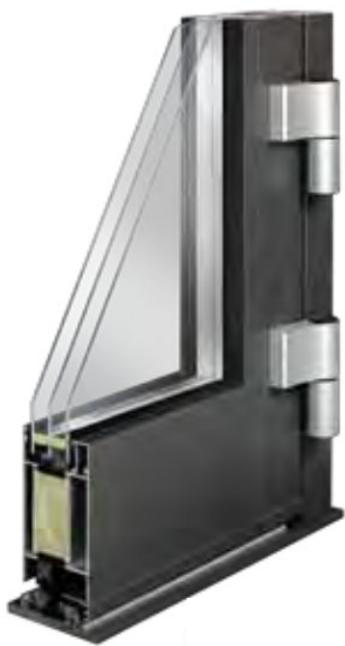
hochwärmedämmte Aluminium-Haustüre bei möglichst geringer Bautiefe - ideal für den Austausch bestehender Haustüren 72 mm Bautiefe
